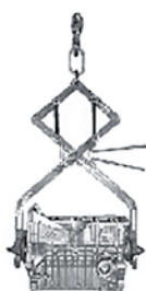
エンジンブロック反転 エンジンブロックを挟んで 上下反転して移動
