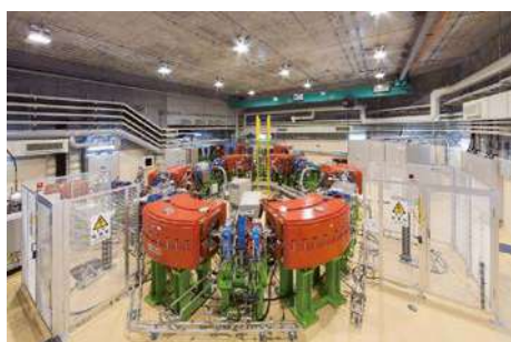
1 階加速器室 (シンクロトロン外観 直径7m 1周23m)
